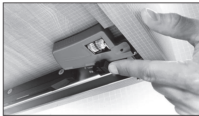
2 Réglage en hauteur (max. + 3,5 mm) Height adjustment (max. + 3,5 mm) Höhenverstellung (max. + 3,5 mm)
